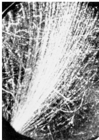
Raggi \beta prodotti da RaC in un campo magnetico di 215 gauss. Le traiettorie dei raggi \beta sono facilmente curvate da un campo magnetico. I raggi \beta possono subire deviazioni importanti e sono relativamente poco ionizzanti, le loro tracce in camera di Wilson sono dunque sottili (H. Staub, Helvetica. Physica Acta 9 (1936) 306).
